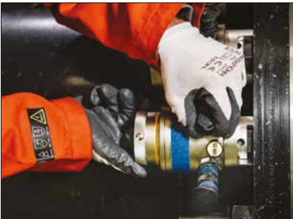
◀ Die HydraMax®-Vorspannzylinder der HM-Serie von Enerpac erzeugen hohe Vorspannkräfte in Verbindung mit Kompaktflanschen und sind dank der maximalen Bolzenabdeckung vielseitig einsetzbar.
