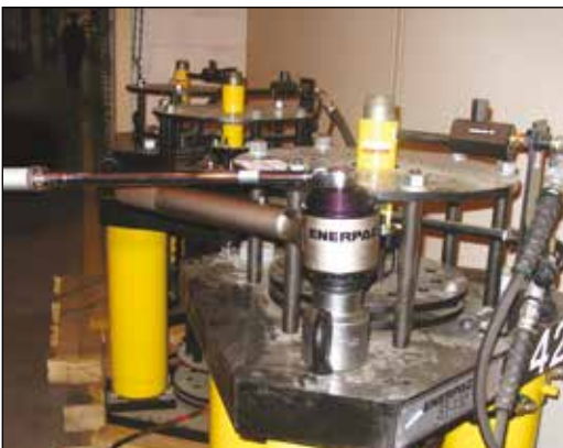
◀ Enerpac Drehmomentvervielfältiger E393 zum manuellen Festziehen und Lösen von Schrauben mit bis zu 4300 Nm.
