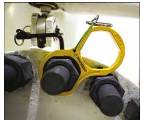
▼ Inserto hexagonal W4206X con unidad de accionamiento W4000PX
