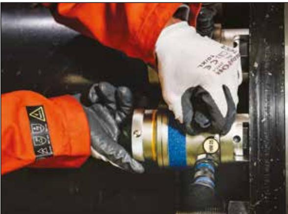
◀ Los tensionadores HydraMax® de la serie HM de Enerpac, han sido diseñados para generar cargas altas en bridas compactas, proporcionando al mismo tiempo versatilidad para una máxima cobertura de pernos.
