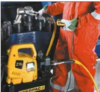
◀ Las bombas para llaves dinamométricas de la serie ZU4T pueden accionar cualquier marca de llaves dinamométricas hidráulicas.
