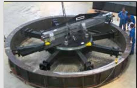
▲ Fresadoras orbitales utilizadas en la construcción naval y generación de energía.
