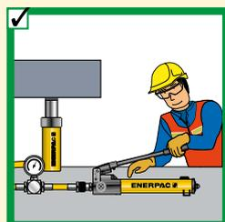
No utilice extensiones para la palanca. Si se usan correctamente, las bombas manuales son fáciles de operar.
