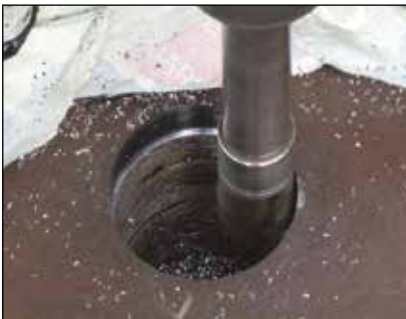
▲ Vergrößern einer Bohrung
