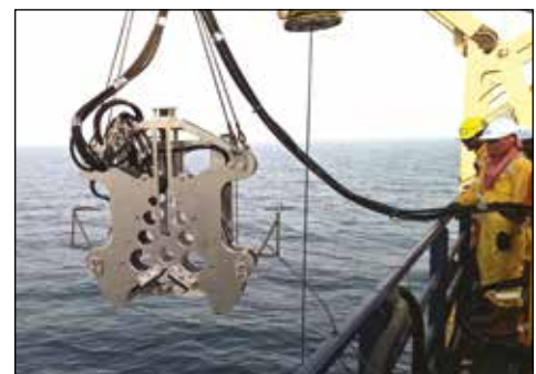
▲ Ins Meer abgesenkte MDWS-Diamantkettensäge.
