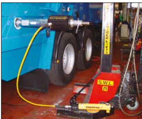
◀ Ein RACH306, angetrieben von einer P392 Handpumpe, dient zum Herausziehen korrodierter Karosseriezapfen aus Entsorgungsfahrzeugen.
