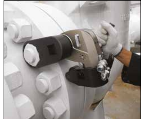
▲ Kundenspezifischer S11000X Drehmomentschlüssel mit kundenspezifischer Drehmomentverbindung und Abstützrolle.
