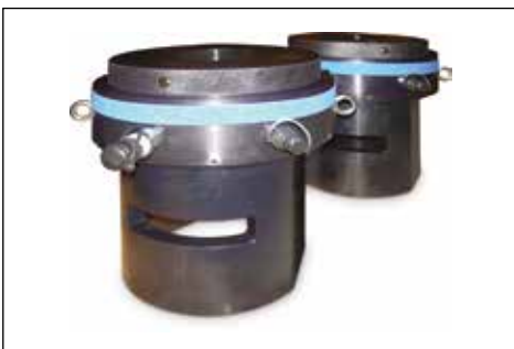
◀ Kundenspezifische hydraulische Vorspannwerkzeuge für 5-Zoll-Bolzen mit einer Belastbarkeit von 4200 kN.
