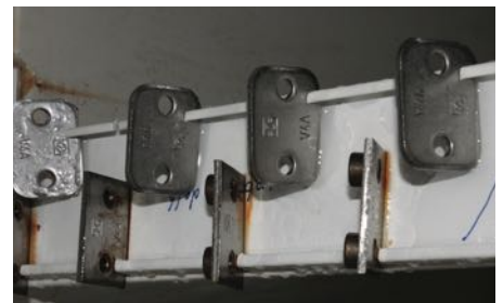
Versuche in der Salzsprühnebelkammer mit ACT Befestigungszubehör (oben im Bild) im Vergleich mit üblichen Edelstahl-Teilen aus V4A (unten im Bild)
